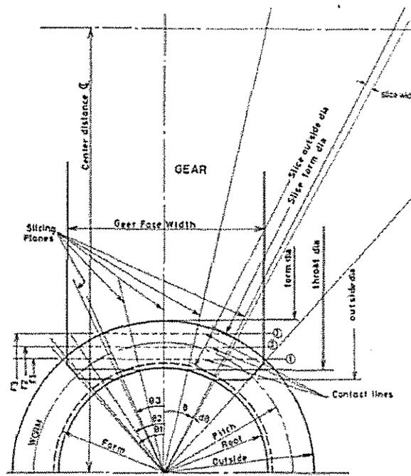
Fig. 1 : Contact lines & slicing planes
